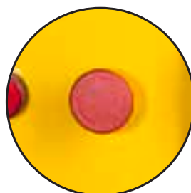
- кнопка аварийного обесточивания станка
