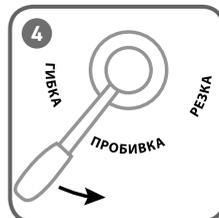
4 Установите распределительный кран в соответствии с проводимым видом работ.
