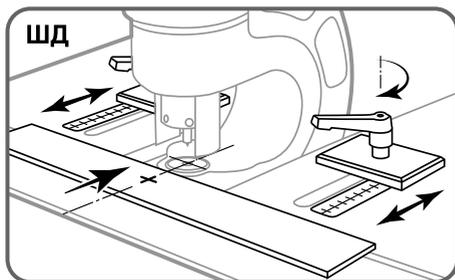
Установите упорные планки для перфорации в зависимости от центра пробиваемого отверстия относительно края шины. Ориентируйтесь на установочные шкалы.
