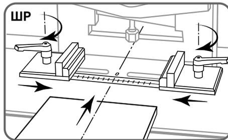
Установите фиксирующие планки для резки так, чтобы продольная центральная ось шины располагалась по центру рабочей зоны инструмента. Ориентируйтесь на установочную шкалу.
