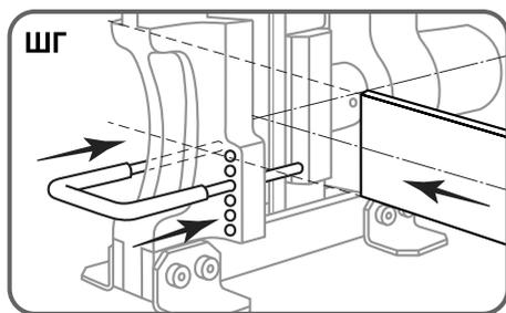
Установите центровочную скобу так, чтобы, центральная продольная ось шины располагалась примерно на одной линии с центральной осью гидроцилиндра.
