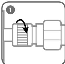
1 Проверьте затяжку соединений на оборудовании стола. При необходимости подтяните соединения.
