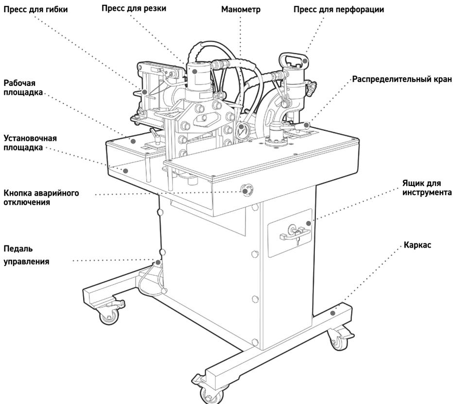
Стол **СШО** представляет собой конструкцию, состоящую из профильного стального каркаса на транспортировочных колесах со стопором, установочной площадки и рабочей площадки. Установочная площадка предназначена для крепления оборудования. На рабочей площадке установлен распределительный кран для переключения потока гидравлического масла, а так же установочные и фиксирующие планки для шин. Кран имеет три рабочих положения: «гибка», «пробивка», «резка».
