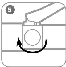
Поверните винт сброса давления в положение «Закрыть»
