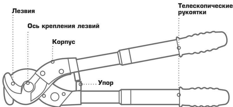
Ножницы кабельные НКТ-30 состоят из лезвий, оси крепления лезвий, телескопических рукояток.
