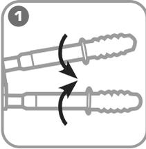
**Расфиксируйте рукоятки, повернув в направлении, противоположном указанному стрелками на ручках ножниц.**
