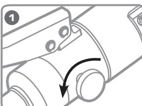
Поверните винт сброса давления в положение «Открыто».
