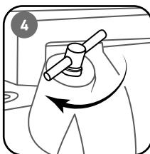
Закройте винт сброса давления.
