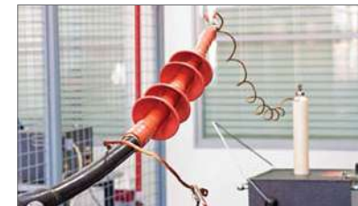
Высоковольтные испытания кабельных муфт
