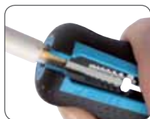
Снятие оболочки с круглого кабеля
