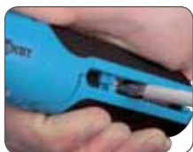
Зачистка коаксиального кабеля
