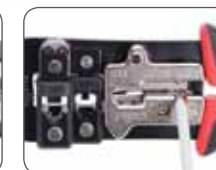
Зачистка круглого провода
