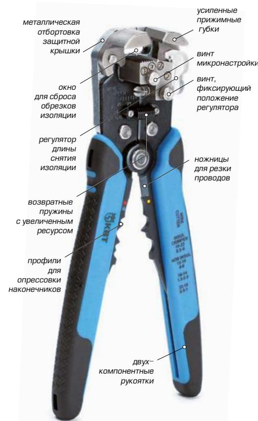
“Продолжение эволюционной линейки стрипперов WS-04 с увеличенной шириной губок и окном для сброса изоляции.”
