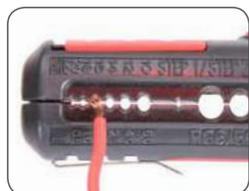
Снятие изоляции с проводов
