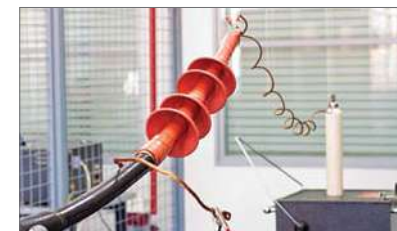
Высоковольтные испытания кабельных муфт
